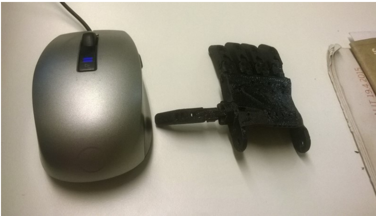
Kuva 9: 3D-tulostettu ja kasattu käsi.
