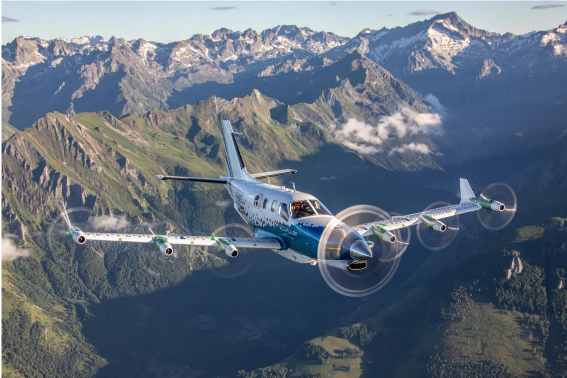
Kuva 12. EcoPulse-projektia varten muunneltu Daher TBM 900. (Airbus 2026)
