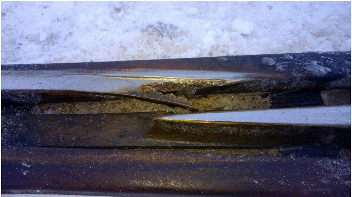
Kuva 16. Siipikiskon repeytyminen tammikuussa 2014 (Varimo L 2015).
