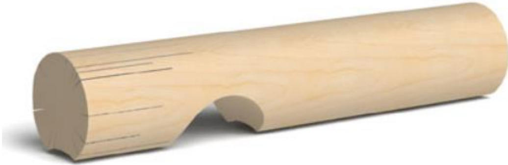
Kuva 6. Ämmännurkka (Puuproffa 2024b)
