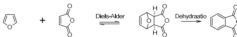
Kuva 6: Ftaalihanhydridin synteesi furaanista ja MA:sta 10
