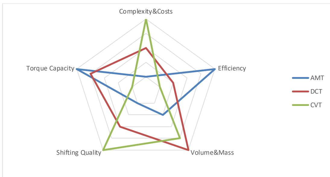
Kuva 10. Moniportaisten vaihteistojen vertailu täyssähköautossa. Mukailten Xu et al. 2018.
