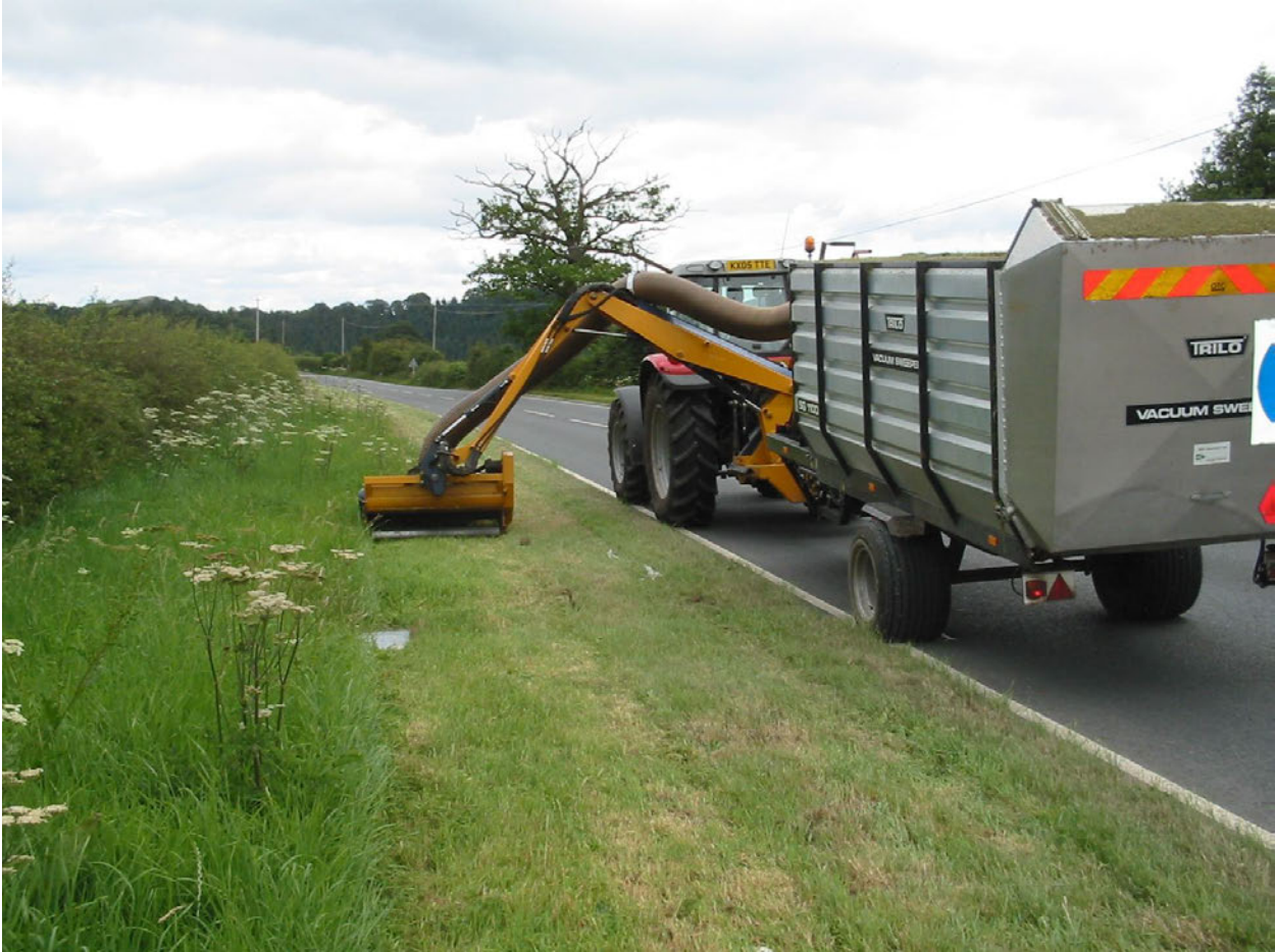
Kuva 2. Tienvarsiniittoihin suunniteltu niitto- ja keräyskalusto Isossa-Britanniassa. Samalla ajokerralla pystytään niittämään ja keräämään niittojäte imutorvella perävaunuun. Kuva: Delafield, 2006, s. 27.
