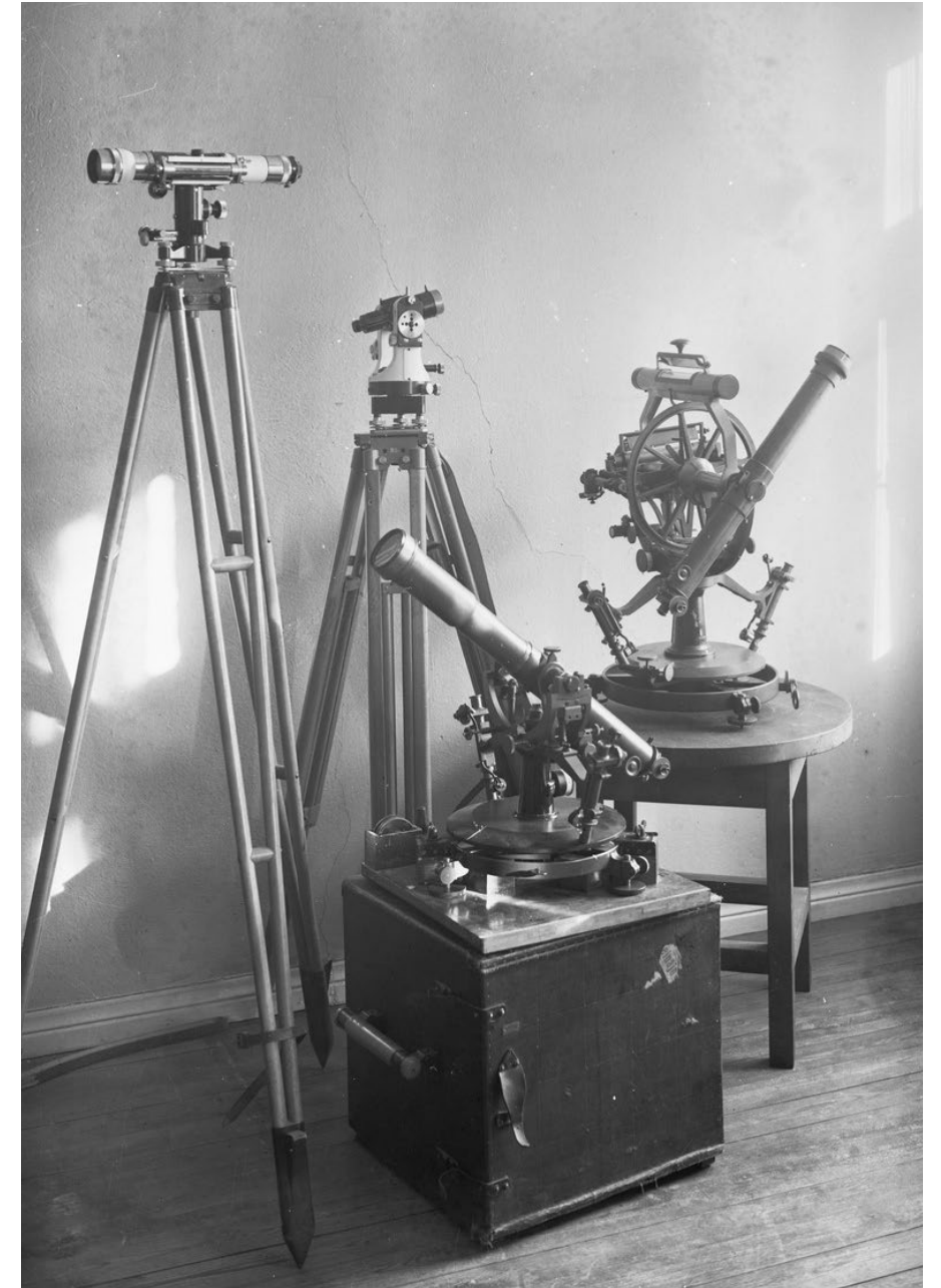
Kuva 6. Teodoliitteja ja muita maanmittauksessa käytettäviä laitteita Geodeesian laitoksessa Helsingissä. MV, P 1934
