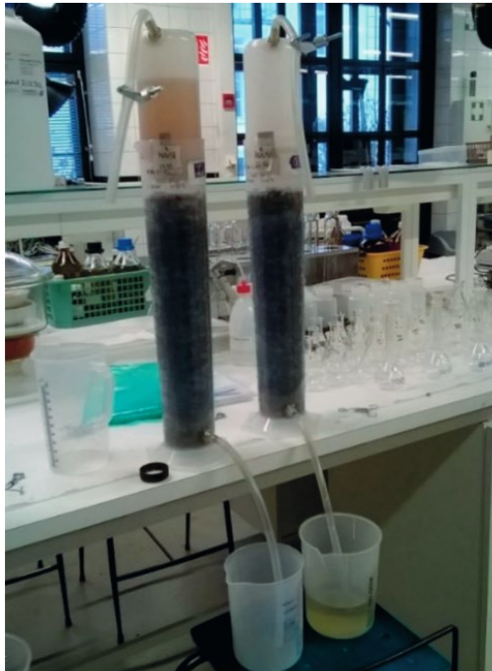
Kuva 8. Sepeli-biohiili-sepeli suodatinkolonnit. (kuva: Niina Laurila) 3
