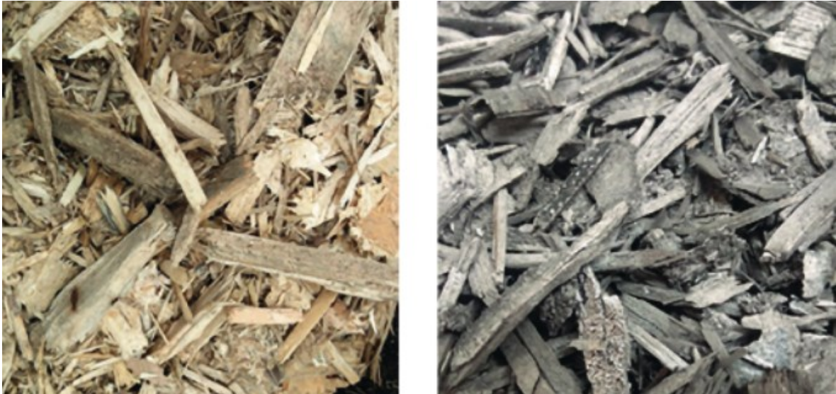
Kuva 7. Vasemmalla kierrätyspuuhaketta ja oikealla pyrolysoituna 600 °C:ssa.
