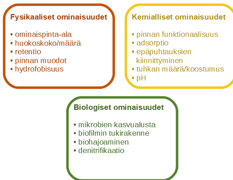
Kuva 4. Biohiilen ominaisuudet, joihin aktivoinnilla voidaan vaikuttaa, mukailten 11
