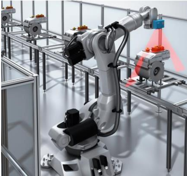
Kuva 10. Esimerkki teollisuusrobotista, joka käyttää LiDARia. (Francis S, 2019)
