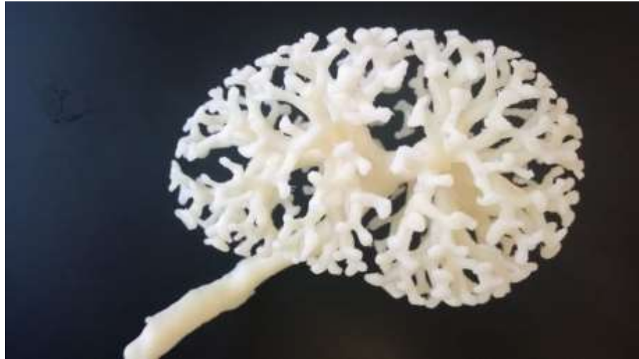
Kuva 11. Kokoojaputkiston mallin C2-a valmis ABSPlus-tuloste.
