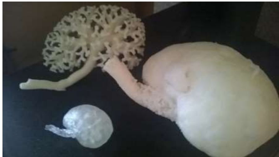
Kuva 12. Kaikkien kolmen mallin tulosteet ylhäältä myötäpäivään: Kokoojaputkisto C2-a, munuainen C1-a ja munuainen C1-b (läpikuultava tuloste).
