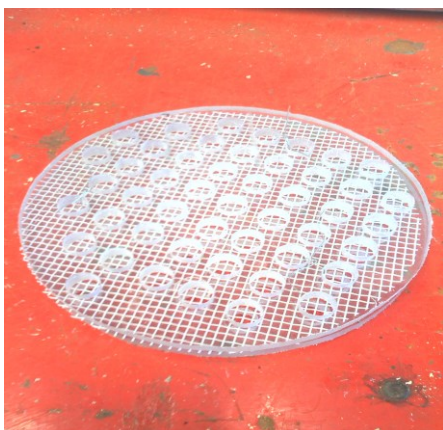
Kuva 7. Eristyslevy, jota käytettiin estämään neutralointimateriaalin siirtyminen pois leijutuskolonnista.
