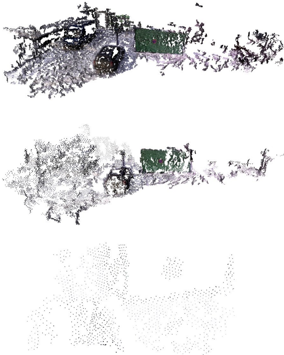
Kuva 17. Esimerkki kuvien resoluution vaikutuksesta pistepilven laatuun. Ylimmän pistepilven muodostamisessa on käytetty resoluutioltaan alkuperäisiä kuvia, keskimmäisessä resoluutiota on pudotettu kertoimella kaksi ja alimassa kertoimella neljä. Kun resoluutiota pudotettiin kertoimella kahdeksan, niin mallia ei saatu muodostettua enää lainkaan.
