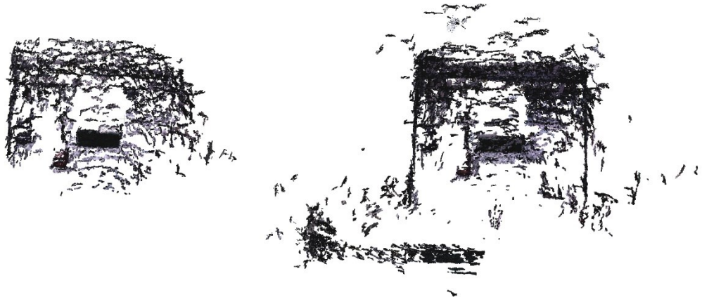
Kuva 16. Kuvassa on kaksi samasta ympäristöstä muodostettua pistepilveä ylhäältä päin kuvattuna. Vasemmanpuoleisen pistepilven muodostamisessa on käytetty 61 kuvaa ja oikeanpuoleisen pistepilven muodostamisessa 629 kuvaa.
