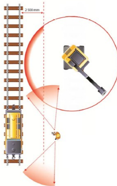
Kuva 3. Työkoneen työskentely yksiraiteisella radalla turvamiestä turvaamana. RSU on 2,5 m lähimmäisestä kiskosta. Kuva: Liikennevirasto 2012a, s. 66
