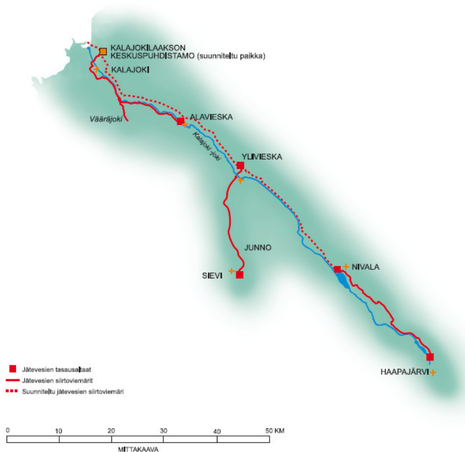
Kuva 7. Vesikolmio Oy:n rakennetut ja suunnitellut siirtoviemärit ja tasausaltaat (Bergbacka 2013).
