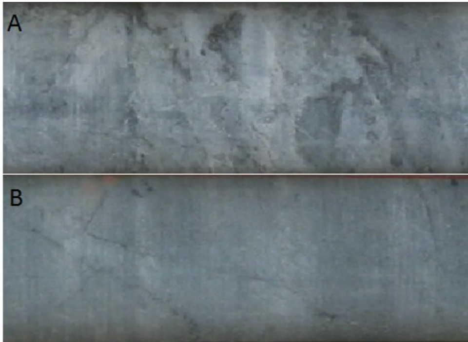
Kuva 9. Kairasydän kuvia. A Laavavirtausten välistä trakyandesiiittistä breksiaa syvyydellä 308,90 m. B Hienorakeista trakyandesiiittia alemmasta laavavirtauksesta syvyydeltä 307,30 m. Kairasydämen leveys 5 cm.
