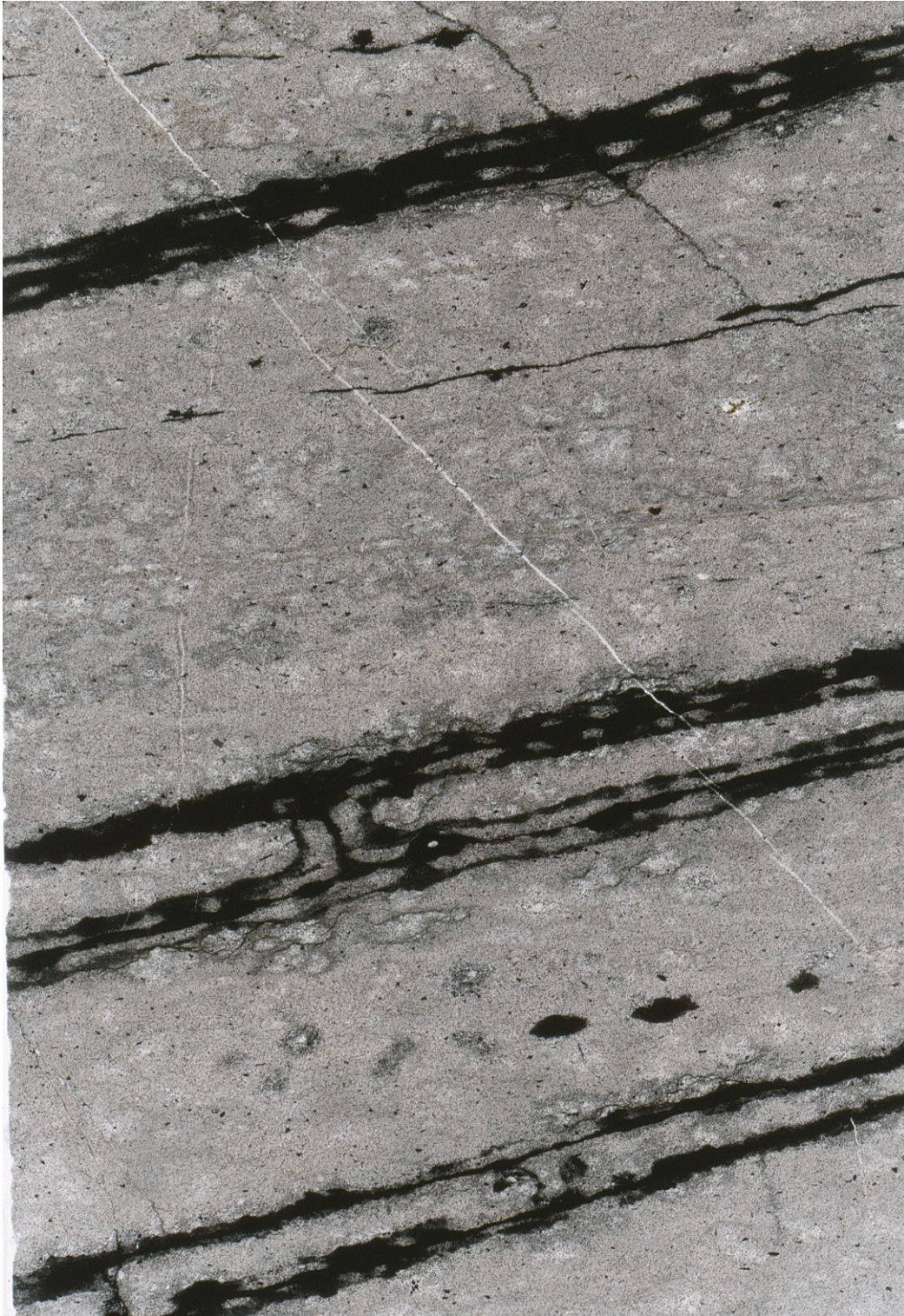
Kuva 19, laavavirtauksen aiheuttamaa raitaista rakennetta (flow banding) ryodasiitissa. Kuva skannatusta hieestä syvyydeltä 124.64 m.
