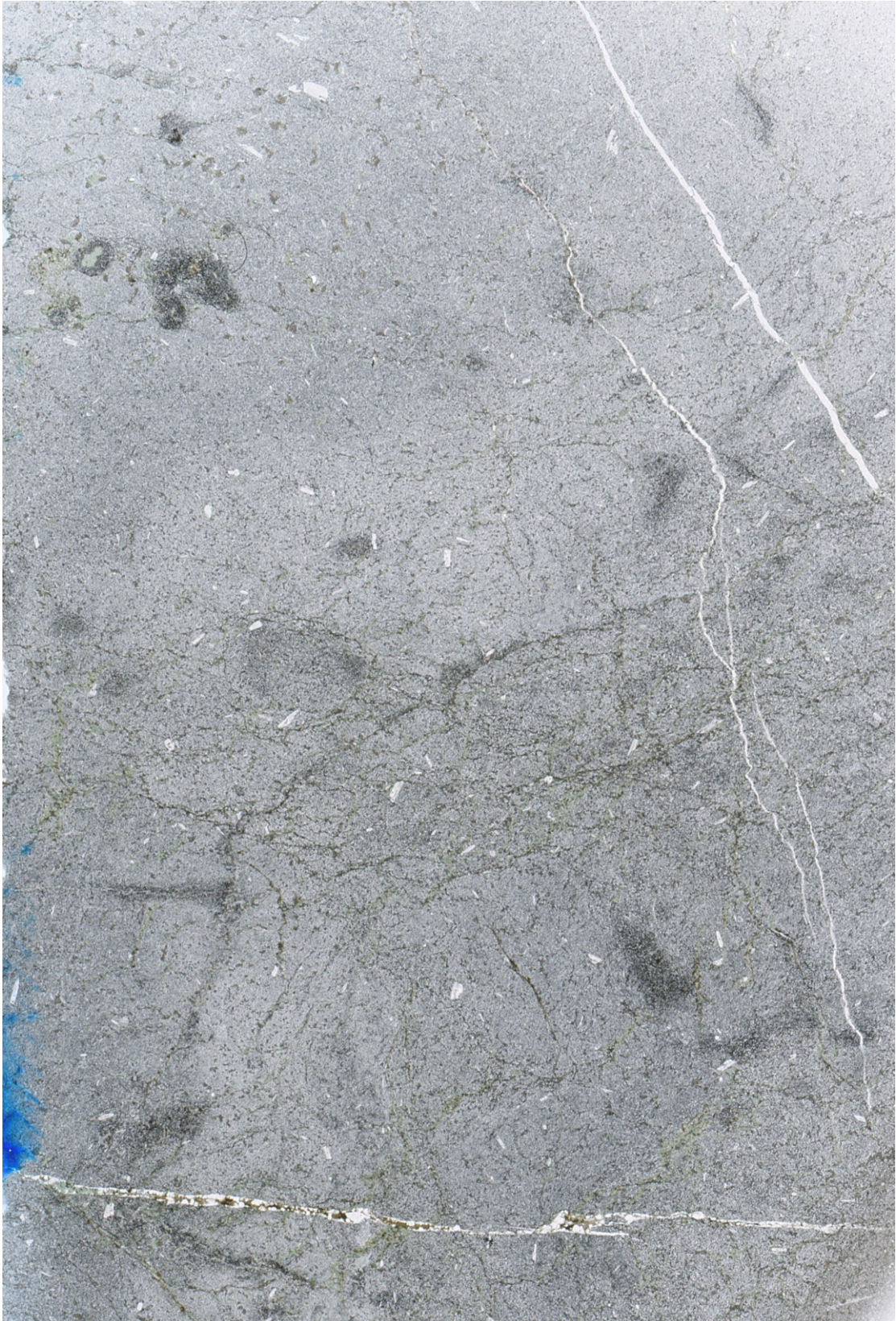
Kuva 8. Kuva skannatusta ohuthieestä yksiköstä A syvyydeltä 309.00 m. Hienorakeista trakyandesiiittiä, jossa osittain omanmuotoisia plagioklaasihajarakeita ja kloriitilla, kvartsilla ja hematitilla täyttyneitä rakoja
