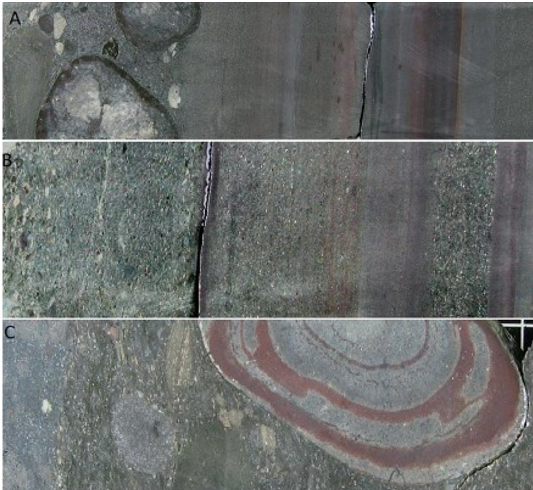
Kuva 31. Kuvia kairansydäimestä 6A. A) Paralleelikerroksellista silttikiveä, vasemmassa reunassa hiekkakivikannatteista konglomeraattia. Syvyys n. 25 m. B) Karkeaa, vulkanoklastista hiekkakiveä, jossa hematiittirikkaita silttikivikerroksia. Syvyys n. 33 m. C) Hematiittiraitainen dasiittiklasti vulkanoklastisessa hiekkakivessä. Syvyys n. 37 m. Kairasydänten leveys 5 cm (Melezhik ja Hanski 2012; Springerin luvalla).
