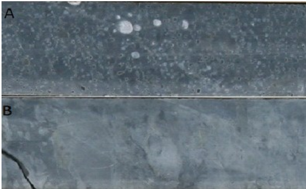
Kuva 22. Kuvia kairansydäimestä 6A. A) Manteleita trakyandesiidissa syvyydellä 189,70 m. B) Trakyandesiidista breksiaa syvyydellä 181,20 m. Kairasydänten leveys 5 cm.
