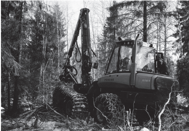
Kuva 27. Monitoimikone tekemässä harvennusta 719 .
