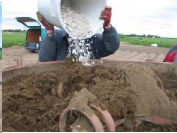
Kuva 19. Maanparannusaineiden (kuvassa kuitu-savi) sekoittaminen ennen sylintereiden täyttöö
