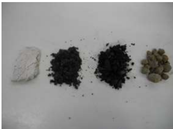
Kuva 14. Maanparannusaineet (vasemmalta: kuitusavi, kuituliete, biohiili ja rakeistettu biotuhka) sijoitettiin maahan erikoisrakenteisella jankkurilla.
