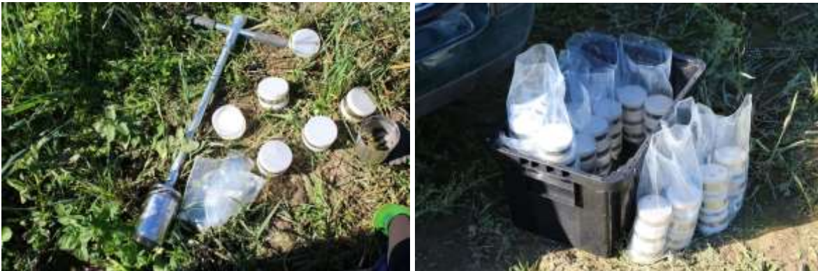
Kuva 18. Eijkelkampin 250 cm 3 teräslieriöt. Näytteistä määritettiin kyllästetyn maan vedenjohtavuus (Ks) ja vedenpidätysominaisuudet laboratoriossa.
