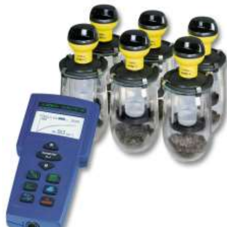
Kuva 4. OxiTop® mittalaite kiinteässä faasissa tapahtuviin biohajoamismäärittäykseen. Myös biohajoamismäärittäykset maassa.
