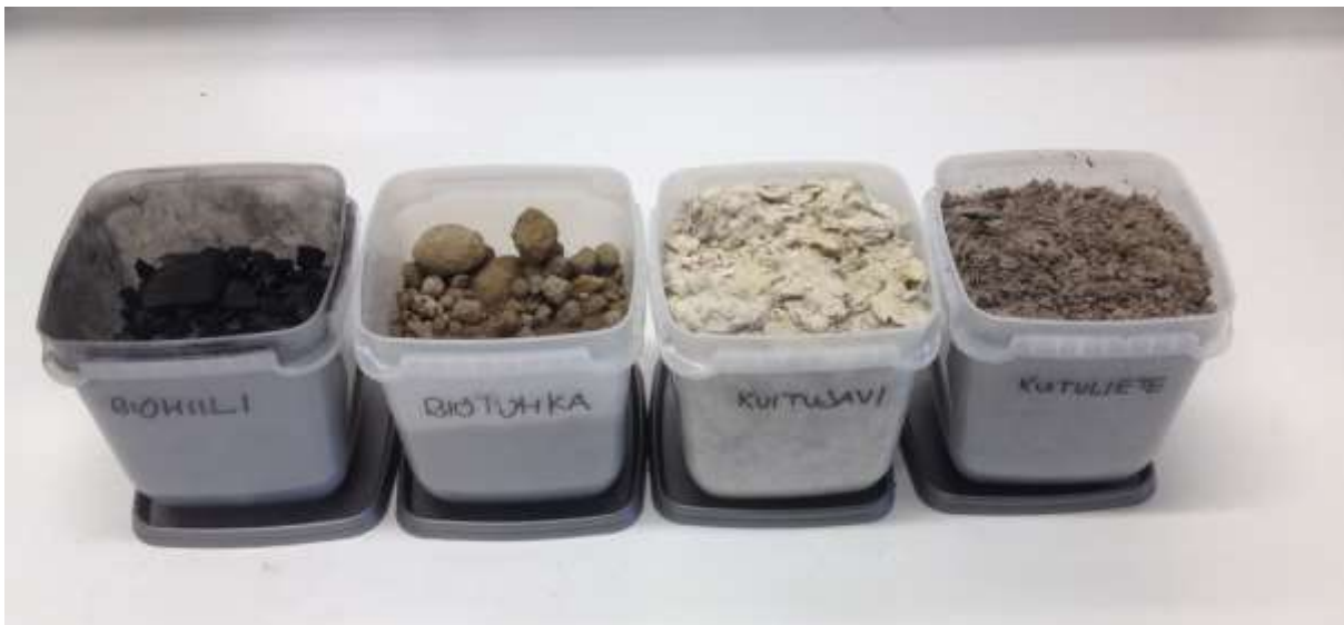
Kuva 2. Testatut maanparannusaineet: biohiili, biotuhka, kuitusavi ja kuituliete.
