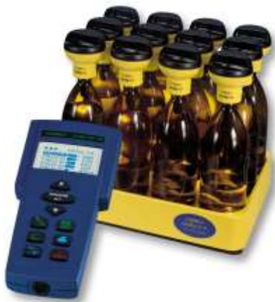
Kuva 3. OxiTop® mittalaite liuosfaasissa tapahtuviin mittauksiin (pohjavesi, OECD 301 F, luonnonvedet, abioottiset tutkimukset)
