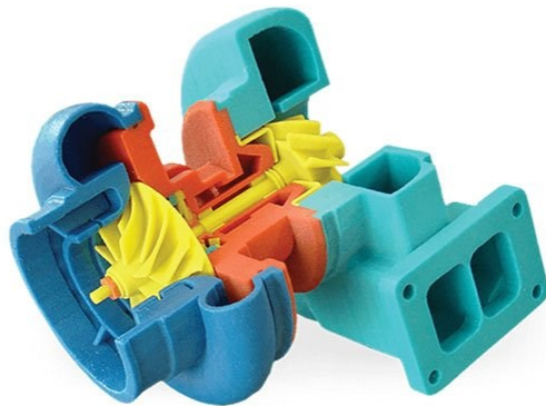
Kuva 7. Binder jetting menetelmällä valmistettu värillinen kappale.(3D Systems 2022)
