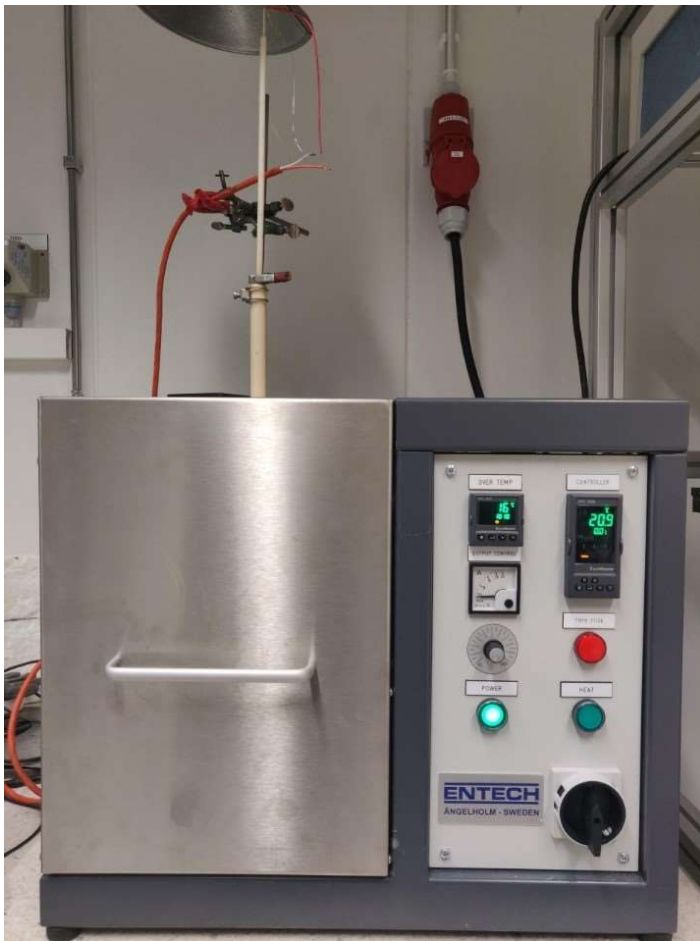
Kuva 2: Lämpökäsittelyyn käytetty Entechin kammiouuni ulkopuolelta kuvattuna.
