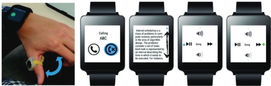
Kuva 8. Synchronwatch [31] prototyypin magneettisesti tunnistettavan sormuksen toiminnallisuus.
