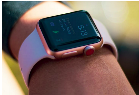
Kuva 1. Apple Watch älykellossa fyysisinä ohjauskeinoina toimivat digitaalinen kruunu, sivunappi ja kosketusnäyttö. [4]
