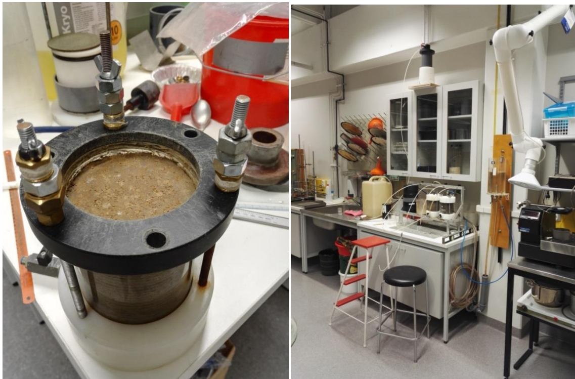
Kuva 14. Kuvassa vasemmalla on vedenläpäisevyyssylinteri, jossa on sullomisvaiheen paino päällä ja kuvassa oikealla on vedenläpäisevyyskokeen koejärjestelyt muuttuvapaineisella laitteistolla.
