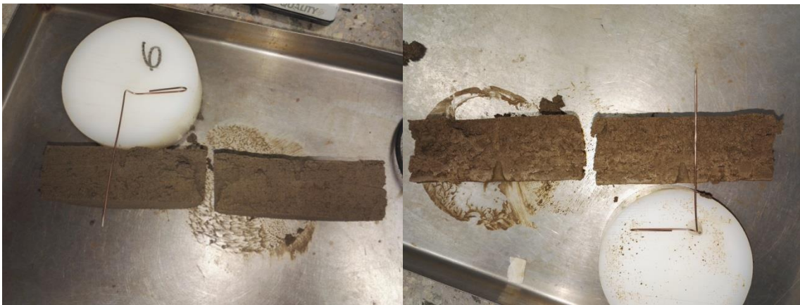
Kuva 18. Näytteet pinholekokeiden jälkeen. Vasemmalla puolella on näyte P2, jossa kokeen aikana läpi puhkaistu reikä umpeutui ja oikealla näyte P3, jossa reikä pysyi avonaisena.
