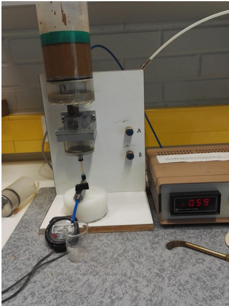
Kuva 16. Kapillaarimetri. Kapeampi sylinteri kuvassa vasemmalla ja tutkielmassa käytetty sylinteri kiinnitettynä kapillaarimetriin.
