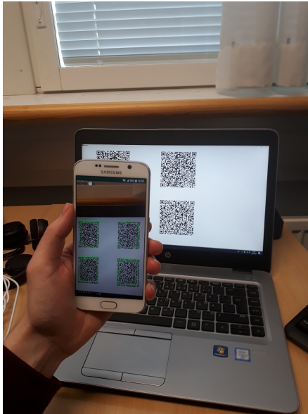
Kuva 4. Toteutetun sovelluksen käyttötilanne. Käyttäjä skannaa kännykällä epäluotetun laitteen käyttöliittymää. Käyttäjä skannaa neljä käyttöliittymässä näkyvää QR-koodia kerralla.
