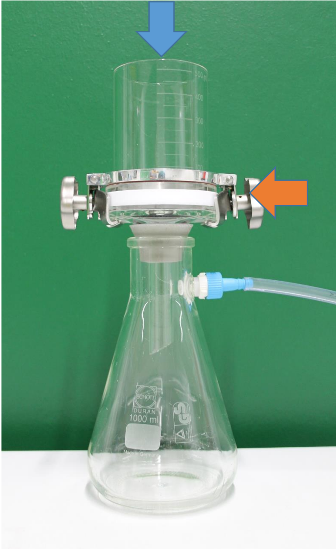
Kuva 4: Ravistelutestin suodatusvaiheen välineistö. Näyte kaadetaan sinisen nuolen osoittamasta aukosta sisään ja kuvassa oikealle lähtevä imuletku on kytkettynä painelaitteistoon niin, että alapulloon syntyy alipaine. Oranssin nuolen kohdalla on suodatinpaperi, jonka silmäkoko on 0,45 \mu\text{m} .
