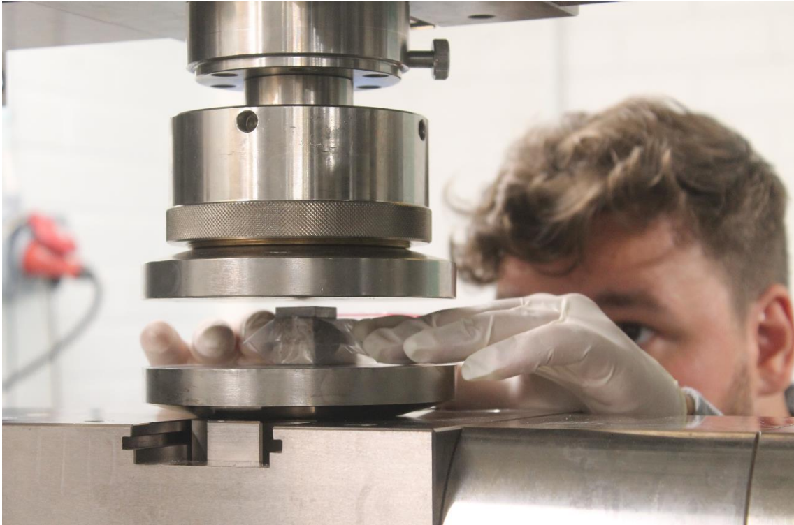
Kuva 3: Puristuslujuusmittauksessa näyte asetettiin pussiin, jotta vältyttiin näytteen pölyämiseltä huoneilmaan.
