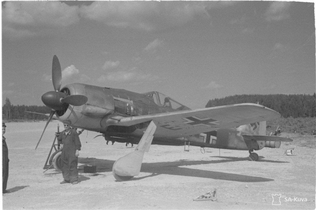
Kuva 5. Focke Wulf Fw 190 F -maataistelukone. Koneen pohjassa on havaittavissa pommiripustin. (Kuva: SA-kuva)
