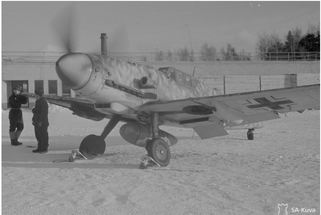
Kuva 3. Messerschmitt Bf 109 G-6 -hävittäjä siipitykkiaseistuksella ja lisäpolttoainesäiliöllä. (Kuva: SA-kuva)
