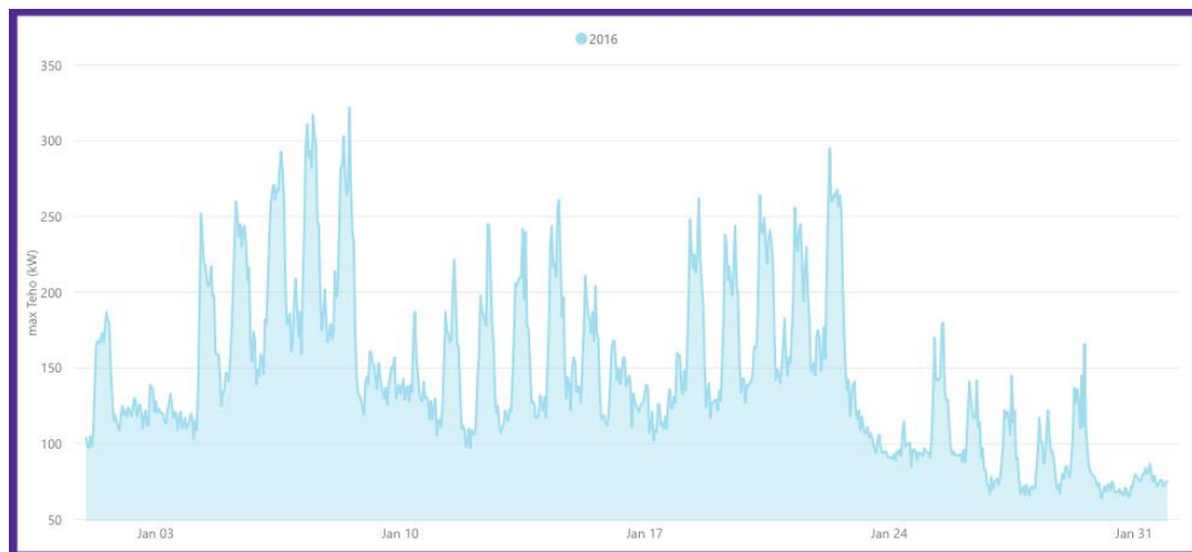
Kuva 18: Kohdekiinteistön kaukolämmön mitattu tunnitainen teho kilowateissa (kW) esitettynä aikajanalla, säätötavan A tarkastelujaksolla.
