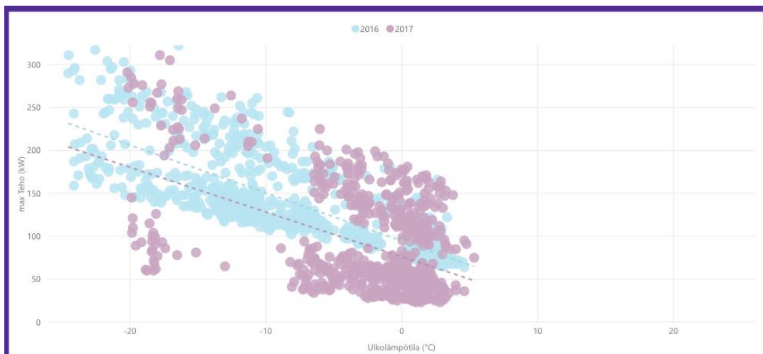
Kuva 21: Kohdekiinteistön kaukolämmön mitattu tunnitainen teho kilowateissa (kW) suhteessa ulkolämpötilaan (°C), sääötäpojen A ja B tarkastelujaksoilla.
