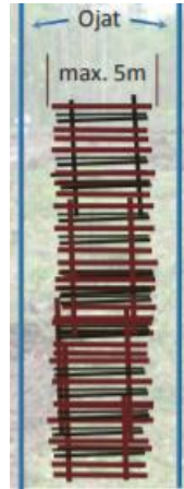
Kuva 3. Telalavan rakenne. (Kiiskinen ym. 2014, s. 28)
