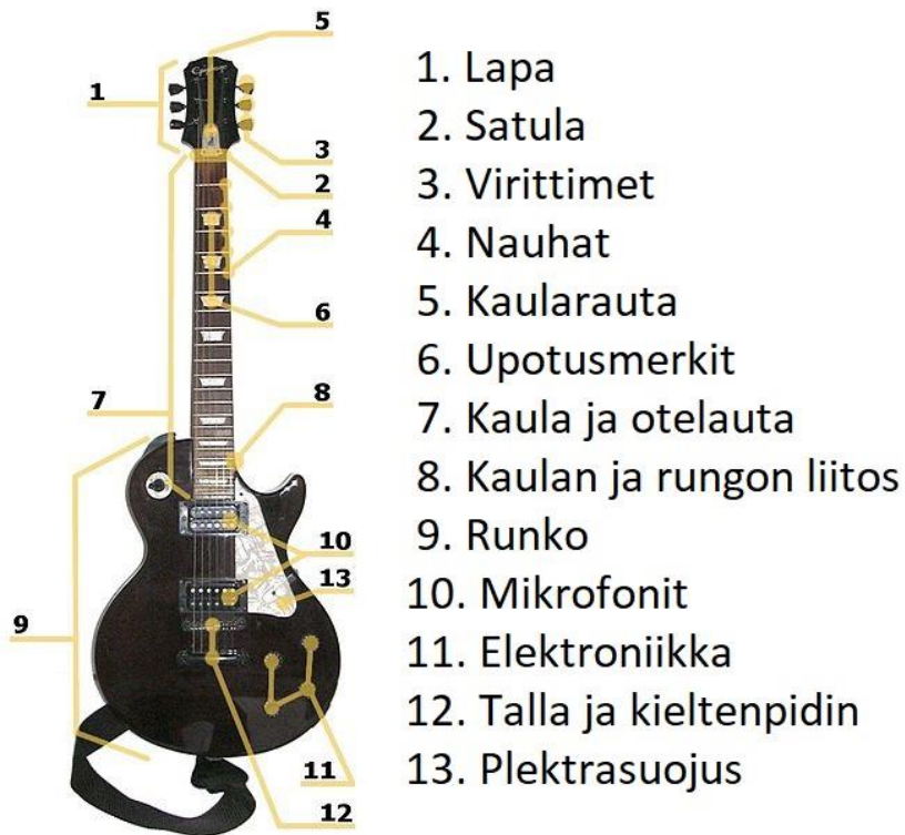
Kuva 1. Sähkökitara ja sen osat./4/
