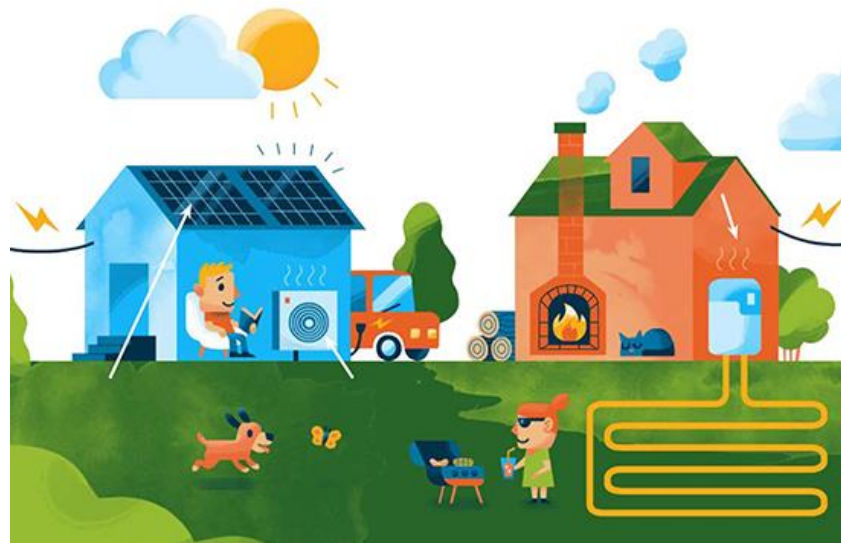
Kuva 8 Esimerkkejä hajautetun energian tuotannon ratkaisuista. Kuvassa aurinkopaneelit, ilmalämpöpumppu, varaava takka ja maalämpöpumppu. (Walemies 2017)
