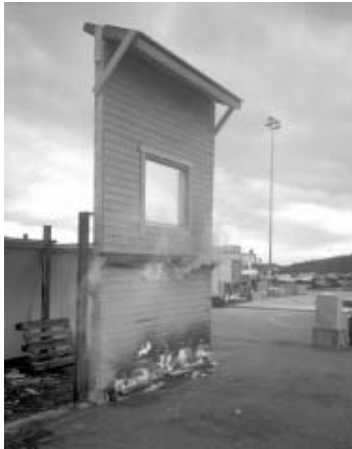
Kuva 3.4.2.1 Puujulkisivujen palokatkopolttokokeita Kuopion Pelastusopistolla vuonna 1998.
