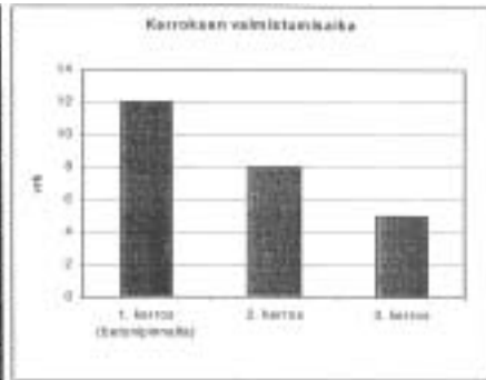
Kuva 4.6.2 Kerroksen valmistukseen kulunut aika puukerrostalo-kohteessa. Harjaantumisen merkitys on näkynyt selvästi maamme ensimmäisiä puukerrostaloja rakennettaessa.
